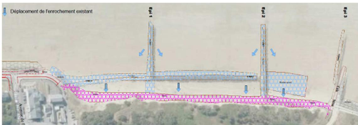
Figure 5 : Photo des travaux provisoires et vue aérienne schématique des travaux de déplacement des blocs réalisés en 2015 dans le cadre des travaux provisoires
