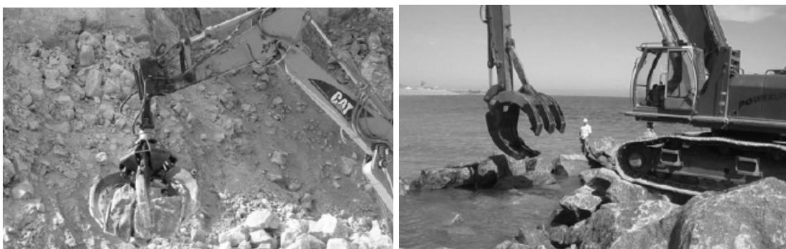
Figure 22 : Exemples de pelles équipées de grappin (gauche) ou pince (droite)
